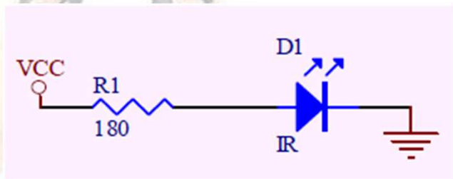
紅外線發射器電路圖
