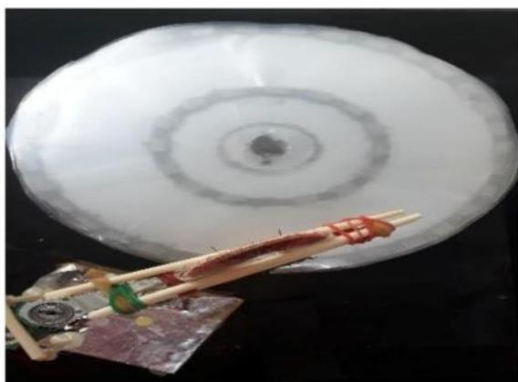
藉由磁場的變化以及介質磁導率的不同，讓通過線圈的磁場產生感應電流，並讀取波型。
