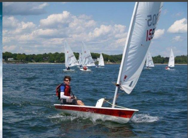
如圖，可以看見風浪板操作者可以以雙手控制帆的方向，而沒有餘力操控尾舵。而帆船選手卻恰恰相反得以使用延伸的操縱桿控制尾舵，但卻只能使用操帆繩使帆固定。但其實無論是哪一種載具僅關乎力矩的控制，愈讓整個船體往哪個方向旋轉即施予相應的力矩即可。
