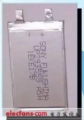
鋰聚合物電池(層疊式鋰離子電池)
