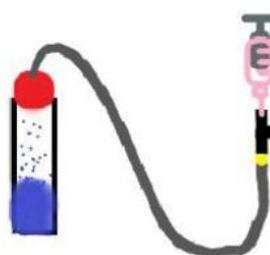
熱導管為常見的電腦散熱裝置，其原理為透過液體蒸發凝結，把熱端的熱源帶到冷端以散熱。而本實驗為簡易熱導管模擬裝置，透過把管內氣壓降到約  $0.024\text{atm}$ ，是用手溫就可以達到沸騰的氣壓。
