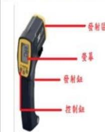
紅外線偵測器的原理和耳溫槍類似，只是其目主要是針對外界物體進行測量。若被測物是黑體，那其能最精準的測量到溫度。若不行，則退而求發射率高的物體。物體的發射率等於物體在一定
