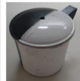
**黑白壺實驗**以水壺代表人體溫度，水壺上的洞代表耳洞(黑體)。首先在水壺裡加入熱水(穩定熱源)，待熱平衡後，分別用紅外線偵測器量測黑色表面，白色表面，以及小孔溫度。因為發射率的關係為小孔>黑色>白色，因此最能代表壺內熱水的溫度(精準度)為小孔>黑色>白色。
