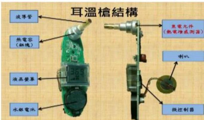
耳溫槍的原理即是利用波導管將耳溫槍所接受到的紅外線傳遞到焦電元件上，焦電元件會將紅外線轉換成數位訊號，再經由微控制器的換算及校準後在螢幕上顯示出溫度。(因耳溫槍量測的耳洞可以視為黑體，因此測量較為準確)
