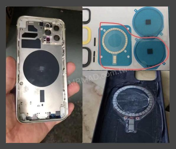
在柔性電路板上也出現五個觸點,其中兩個焊接連上最外圍的空心銅線圈,且這些線圈非常細,由此可判斷,除了能提供磁吸,也同時會具備 NFC 功能,讓無線充電和 NFC 兩者不受影響。
