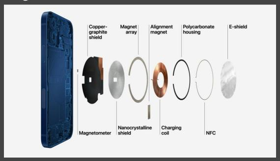
那麼又會有人好奇,如果我沒買 MagSafe 保護殼能不能用? 裸機情況下當然可以!在 iPhone 12 內側機背·就額外加入 34 個磁鐵,並排成圓形環繞在無線充電線圈外圍,另外還有加入兩 個大磁鐵,總共數量達到 36 顆。值得注意是,磁吸式環形外圍 能夠看見金色 FPC 柔性電路板和線圈組成的 NFC 模組。
