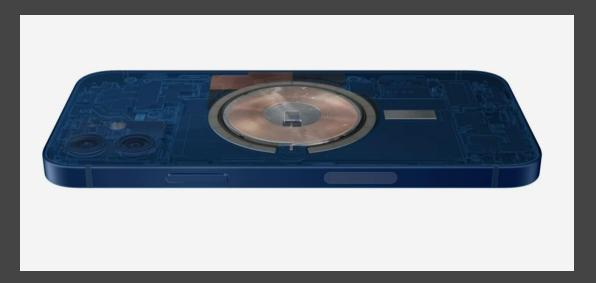
為了能夠讓 iPhone 無線充電效率達到 15W ,直接改進屏蔽層設計(E-shield),能以更安全的方式來實現高達 15W 快速充電,同時也制定奈米級晶體面板(Nanocrystalline)用來捕捉磁通量,還增加兩個新的傳感器,分別是單匝線圈 NFC 和高
