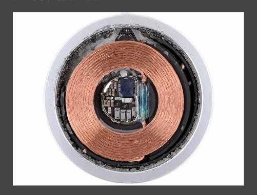
MagSafe 無線充的頻率是直接使用 Apple Watch 磁吸無線充相近的頻率 360Khz 左右(實測在一定範圍內都可以), 顯然這個頻率是蘋果經過各種驗證測試得到,採用這個頻率是因為這個頻率對磁鐵的影響最小。
