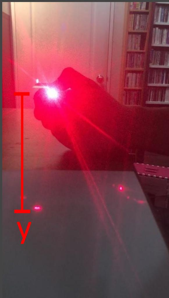
二、用已知波長的光源求 $L$ ， $L$ 為透射光柵到假想屏幕的距離(即照片本身)，用雷射筆以水平方向照射黏上光柵片的手機鏡頭，測量手機上光源到一階亮紋的距離 $y$ 然後帶入公式  $d \sin\theta = \lambda$  即可得知  $L$ ，其中  $\theta = \tan^{-1}(\frac{y}{L})$ 。
