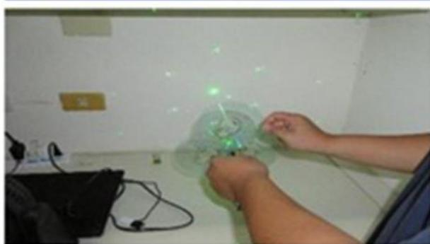
光碟片上是由一道道微小光柵所組成，當雷射光通過的時候會在後方產生繞射，出現類似於繞射條紋的光點。可用於構成圖案甚至立體影像。
