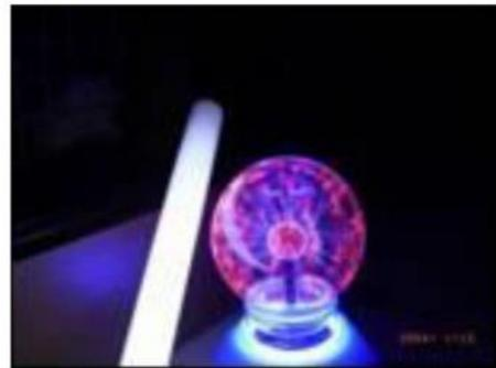
將日光燈管靠近電漿球，發現燈管亮了，那是因為電漿球的底座的高電壓使得日光燈管裡的汞(水銀)激發產生光，這些光打在塗在燈管壁上的螢光劑，發出像日光一樣的白光。
