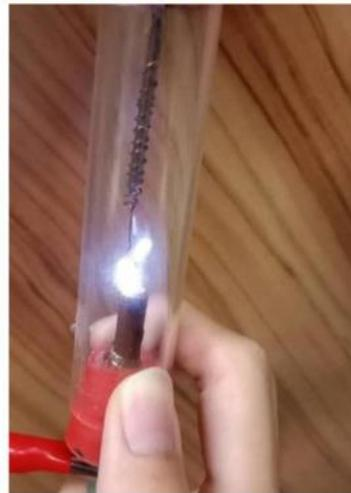
管內壓力降低，崩潰電壓下降，因此即使兩金屬即使沒有接觸依然可以導電。
