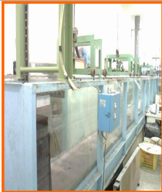
圖 2-1 造波水槽(12m×0.5m×0.7m)
