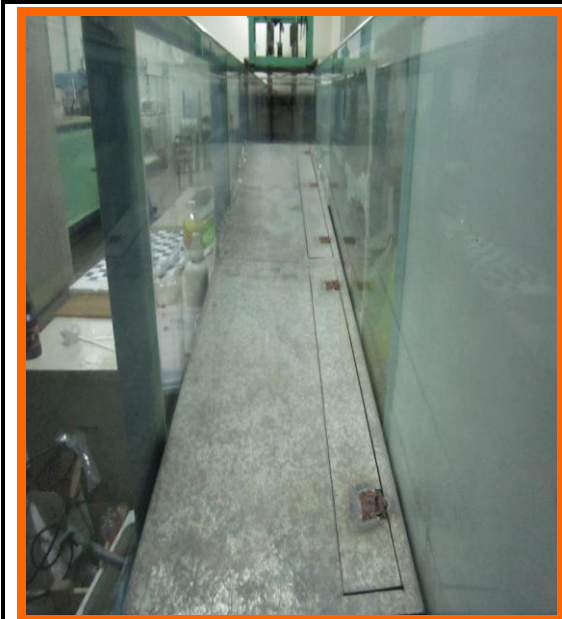
圖 2-7 斜坡放置水槽內部
