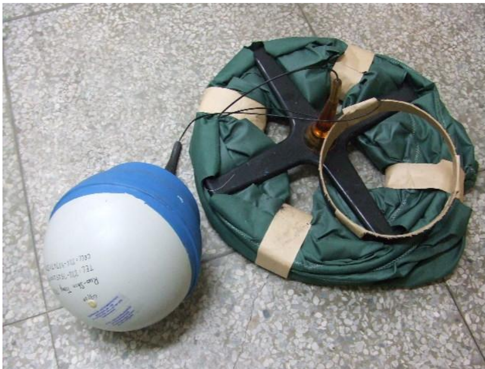
圖 2-2 迷你型洞襪式 Argos 浮球：迷你型浮球直徑為 38 cm，托傘分為 4 層，總長度為 4.88 m，重 20 kg，每層 1.22 m 長，托傘直徑為 61 cm。托傘每層有兩個圓洞相對，相鄰兩層的圓洞為 90^\circ 交錯。
