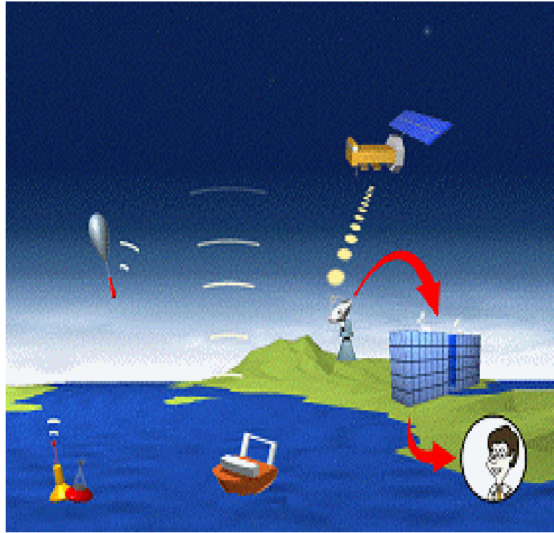
圖 2-1 Argos 衛星定位系統示意圖(摘自 NOAA/AOML 網站)
