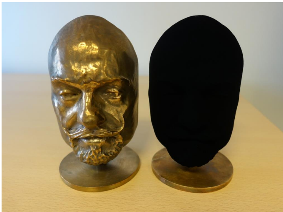
圖 1-4 兩個相同的青銅頭像，一個未做任何處理，另一個塗上 Vantablack 材料 (Surrey NanoSystems®)[11]。
