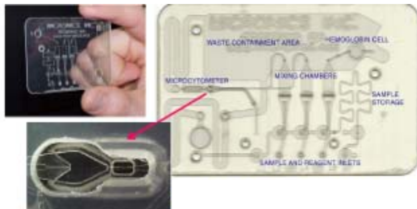
圖 1.19 美國 Micronics 公司所生產之整合型微流體晶片( ORCA chip )[36]
