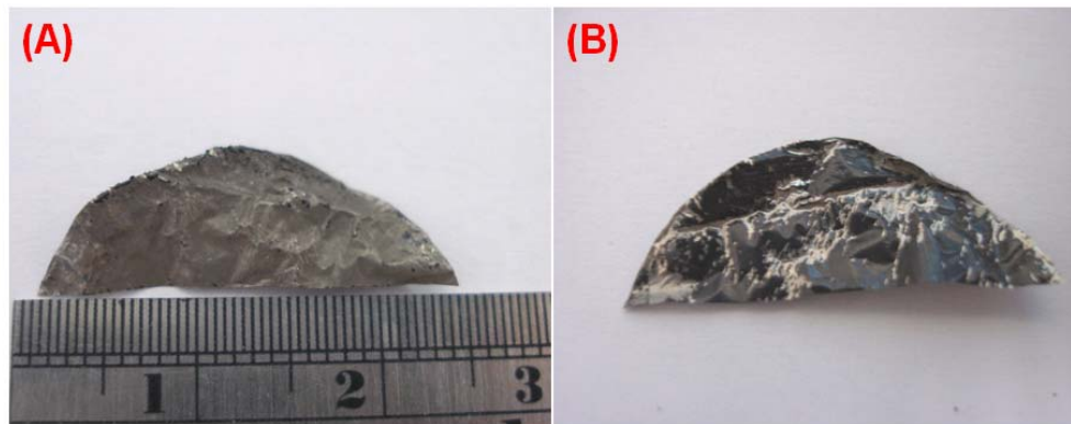
圖3-3 以無電鍍鈇浴 B 製備之鈇奈米組合電極 (A)未撕除表面鈇前，表面皺摺不平整； (B)以膠帶撕除單面鈇，有部分鈇未能移除。
