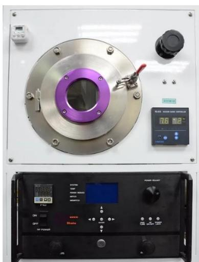
圖 3-3 本研究使用之低真空的感應耦合電漿系統。上方為低真空反應腔體搭配派朗尼真空計，下方為高頻電源供應器用於提供上方腔體產生高頻電漿。
