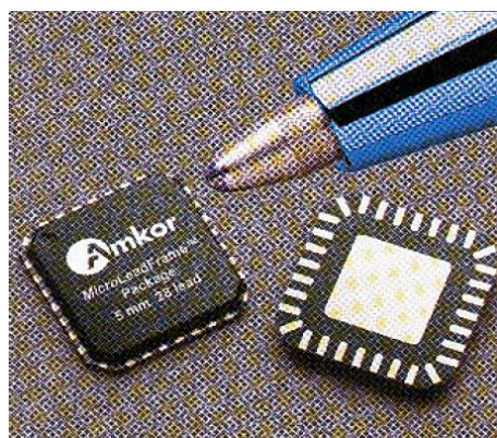
圖 1-3 QFN:封裝的 IC 樣貌[1]
