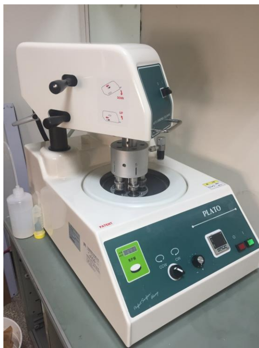
圖 3-8 本實驗室所使用具有自動研磨手臂的研磨機
