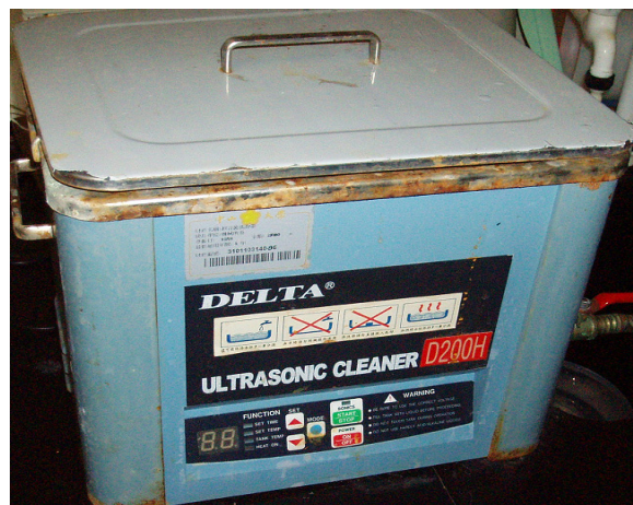
圖 2.9 利用超音波震盪機蝕刻
