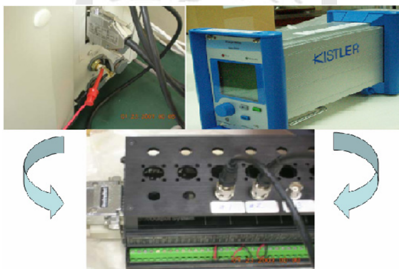
圖 3.1 MTS 與 Charge meter 訊號經由 Data-Logger 同步擷取
