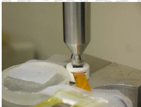
圖3-30 利用壓印頭進行對位示意圖(確保力量傳遞)
