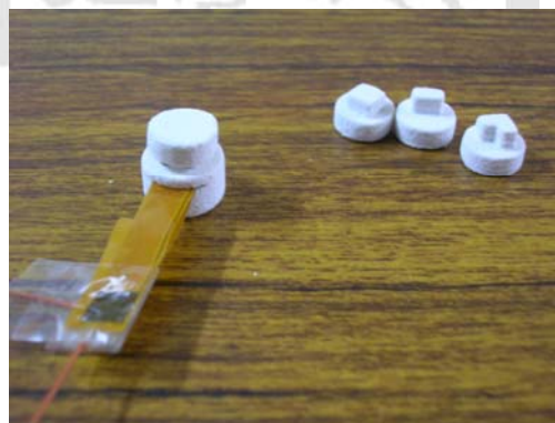
圖3-32 不同承受面積之壓印頭—快速原型製作
