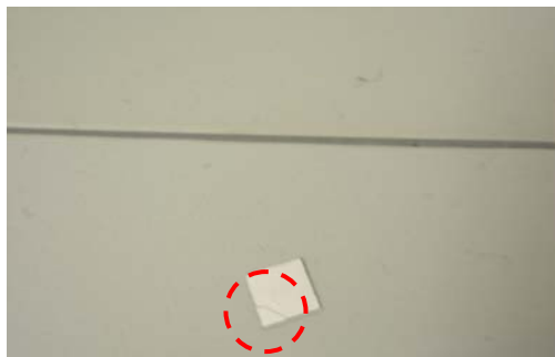
圖3-35 承受500N後，經手碰即破壞的試片圖
