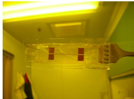
十三、冷卻至室溫後以氯化鐵溶劑進行蝕刻 十四、用丙酮擦拭後完成品
