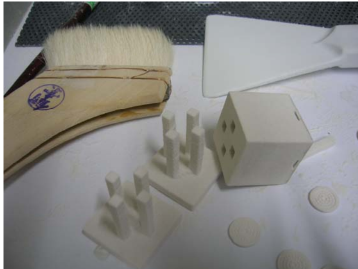
圖3-33 特性實驗探討之模子—快速原型製作
