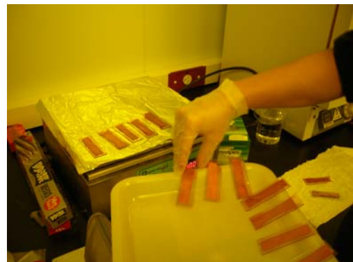
八、旋塗後進行100°C軟烤3min.
