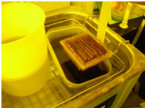
十三、冷卻至室溫後以氯化鐵溶劑進行蝕刻 十四、用丙酮擦拭後完成品
