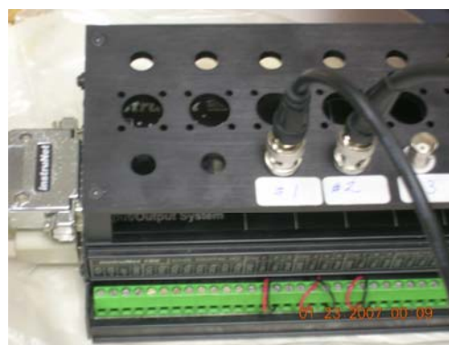
圖2-21 類比信號輸入紀錄器示意圖
