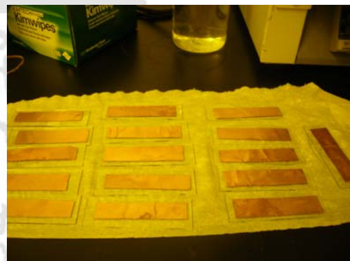
五、用雙面膠將基材固定在玻璃試片 六、電極製作之基材準備完成
