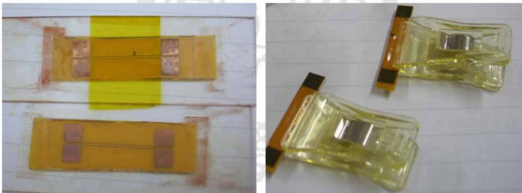
圖2-18 利用PI膠帶避免訊號線因碰觸而短路
