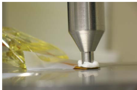
圖2-13 自製壓印頭透過保麗龍傳遞力量
