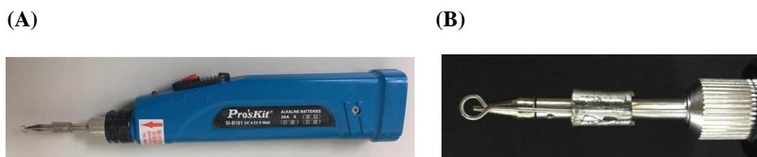
圖 3-9 熱脫附探針。(A)電池式電烙鐵，(B)外接不銹鋼接種環。
