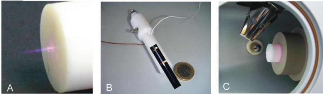
圖 1-5 介電質放電氮氣電漿游離源[9]。
