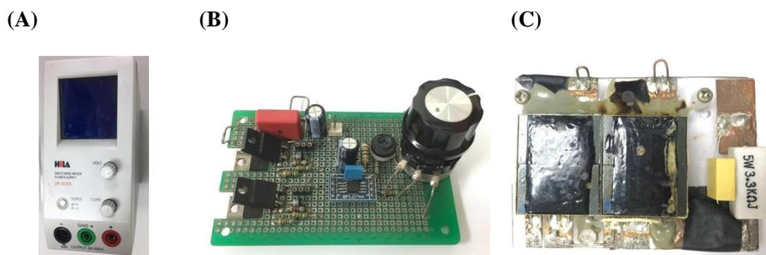
圖 3-8 電漿產生模組。(A)直流電源供應器，(B)雙輸出脈衝產生器，(C)高壓變壓器。
