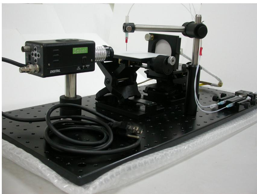
圖 4.3 接觸角量測儀實體照片示意圖
