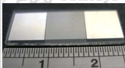
圖 3-4 量測晶片實體圖(公分)
