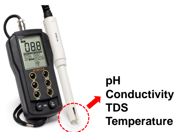
圖 1-8 商用手持式整合電極多參數檢測計。哈納儀器公司生產之 HI9813-6™ 將 pH 電極、電導度電極與 NTC 溫度感測器整合在一根電極內，同一時間只進行 pH 值或是電導度(TDS)的量測，溫度感測則可持續進行量測。
