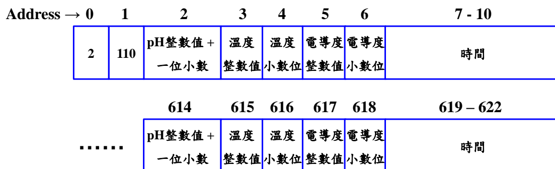
圖 3-5 資料儲存在 EEPROM 內示意圖。位址 0 與 1 負責記錄目前資料儲存到的位址，一筆完整循環量測的資料量為 9 個位元組。
