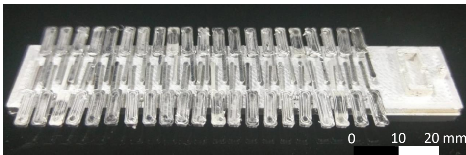
圖 3-4 濺鍍完成之電極陣列。(A)金，(B)銀
