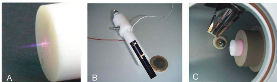
圖 1-9 DBDI 氬氣電漿質譜游離源[24]
