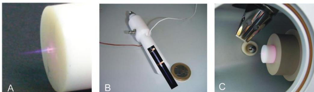
圖 1-9 介電質放電游離源(A)電漿噴焰、(B)環狀電極結構、(C)樣本量測示意圖
