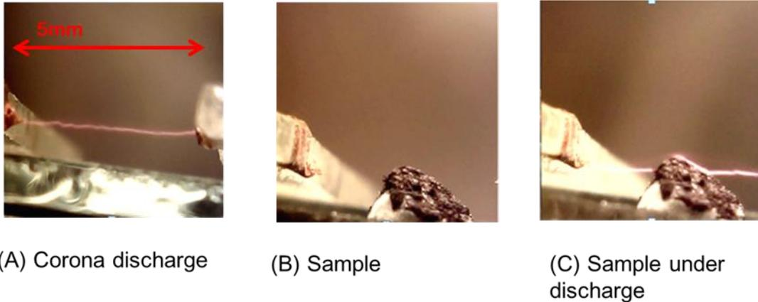
圖 3-3 樣本在電暈放電底下的特性(A) 電暈放電束、(B)放置樣本、(C)放電沿著樣本表面通過
