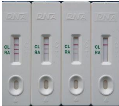
圖 1-3 克倫特羅與萊克多巴胺檢測卡匣實體圖[7]。此為檢測肉品中瘦肉精成分之多重檢測卡匣，能夠一次檢驗肉品中是否殘留克倫特羅和萊克多巴胺。
