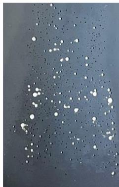
圖 3-2 殘餘水分子於退火後造成的圓形破裂。
