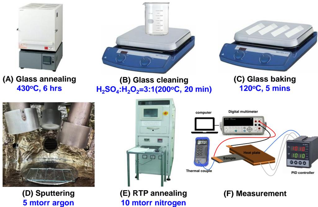
圖 3-1 薄膜製備流程圖。薄膜的製備包含(A)玻璃的退火、(B)清潔及(C)烘烤，(D)主要的濺鍍，接著進行(E)熱處理最後則是(F)各性質量測。
