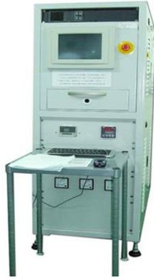
圖 3-5 快速熱處理系統裝置圖。
