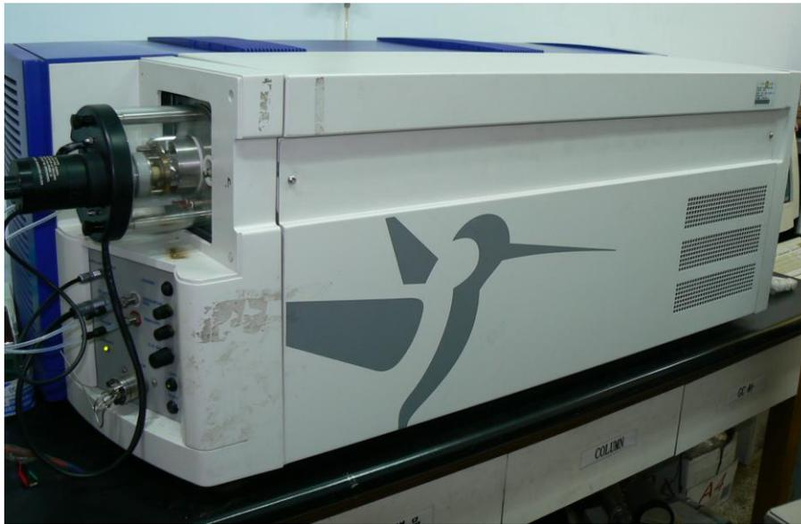
圖 4.8 三段式四極柱氣相質譜分析儀
