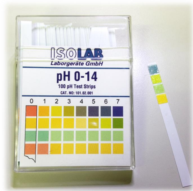
圖 1-1 實驗研究經常使用的廣用試紙。量測範圍可從 pH0 至 pH14，但只能利用比色法對溶液做粗略的酸鹼值判斷。
