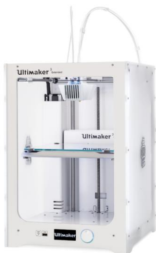
圖 3-1 本研究所使用的雙噴頭 3D 列印機。為龍門式的設計，具有兩個擠出頭以及加熱板，可以在單次的列印過程中，同時列印兩種材料。
