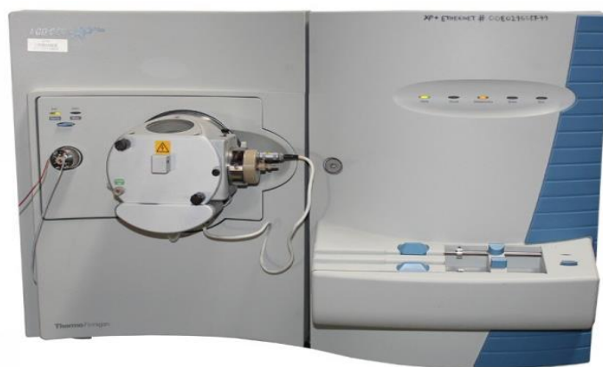
圖 3-6 本實驗所使用的 LCQ Deca XP Plus 離子阱式質譜儀。
