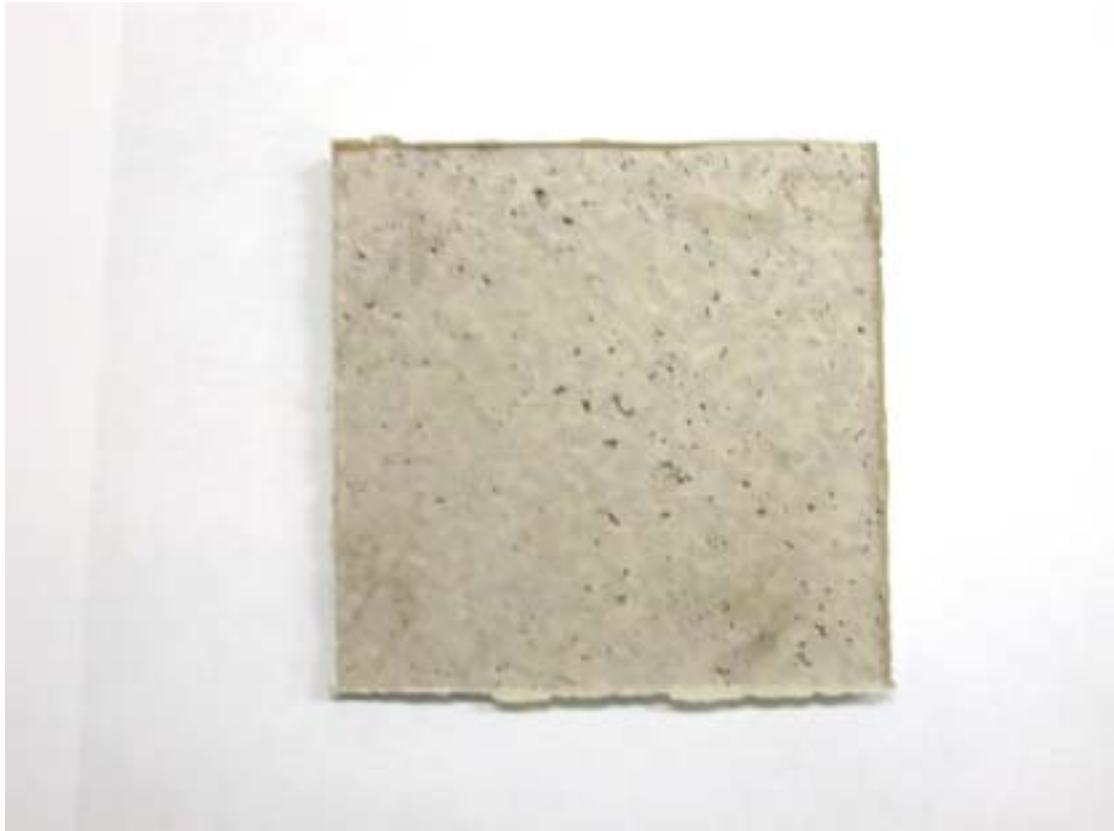
圖 3.2 壓力過低下成形的 PEEK 板材
