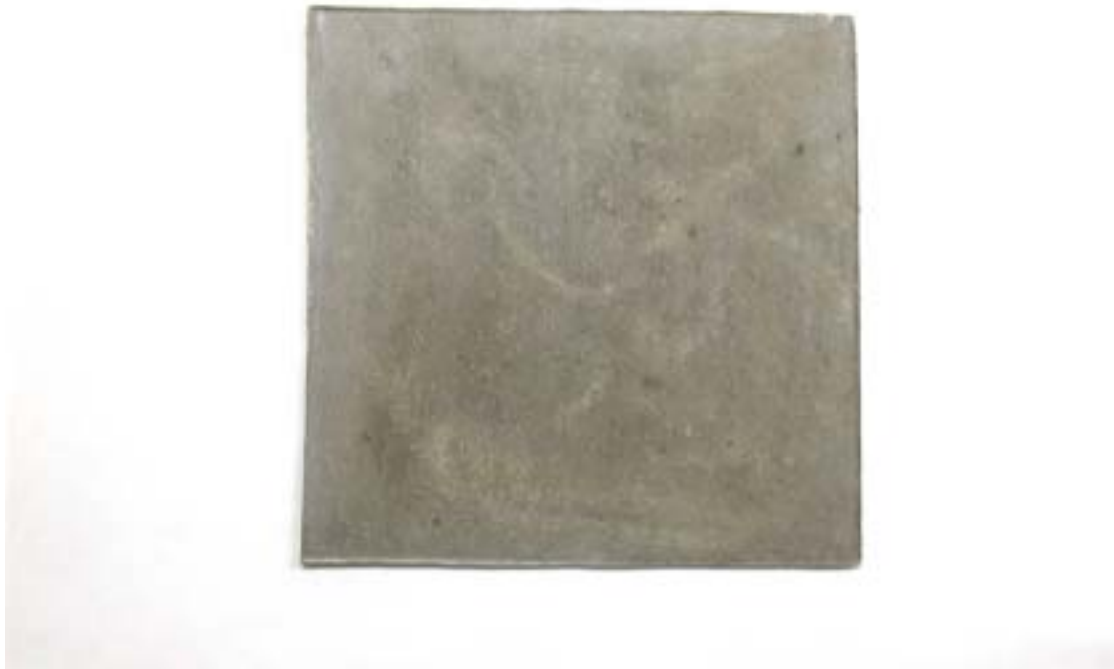
圖 3.3 兩段式加工成形的 PEEK 板材
