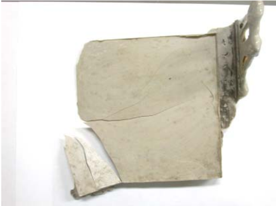
圖 3.1 在 440°C 時直接加壓成形的 PEEK 板材
