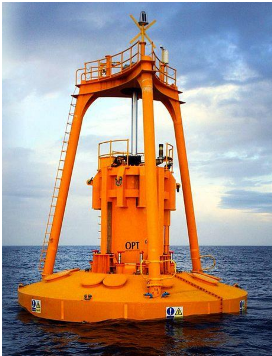
振盪浮子式 波浪發電機
