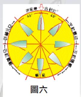
但帆船航向並不是完全沒有限制(在固定帆身與帆的角度之下),逆風左右各約45度,是無法產生有效推進力的。此外,太順風也不太好,因為此時白努力效應減弱,而少了白努力效應的推動力,因此當船的速度越來越快,阻力也開始漸增。與風向成一定夾角,在白努力壓力的推動下,能得到持續且穩定的推動力。
