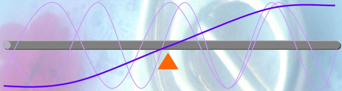
為起初摩擦金屬鋁棒時，金屬鋁棒內部所產生不同頻率震動之波形。
