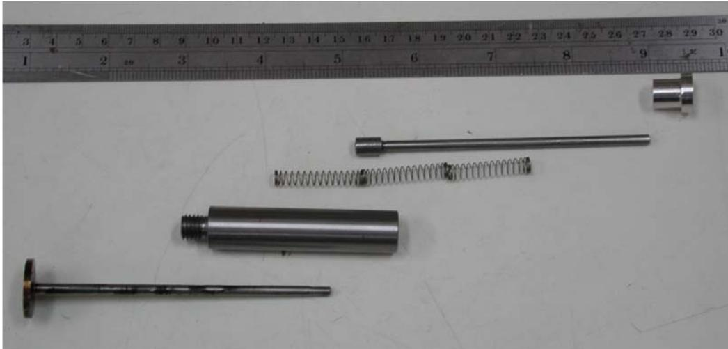
圖 4-11 輔助長度測量錶量測鼓脹高度之機構
