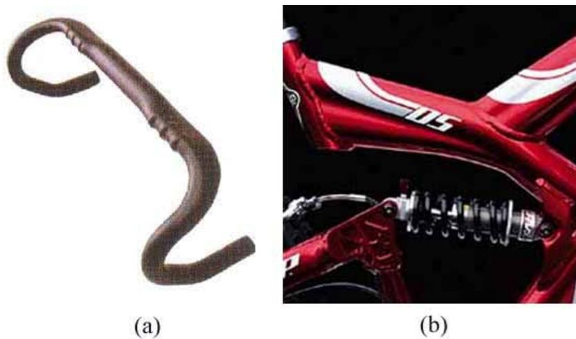
圖 1-5 應用管材液壓成形製程之自行車元件(a)把手；(b)車架
