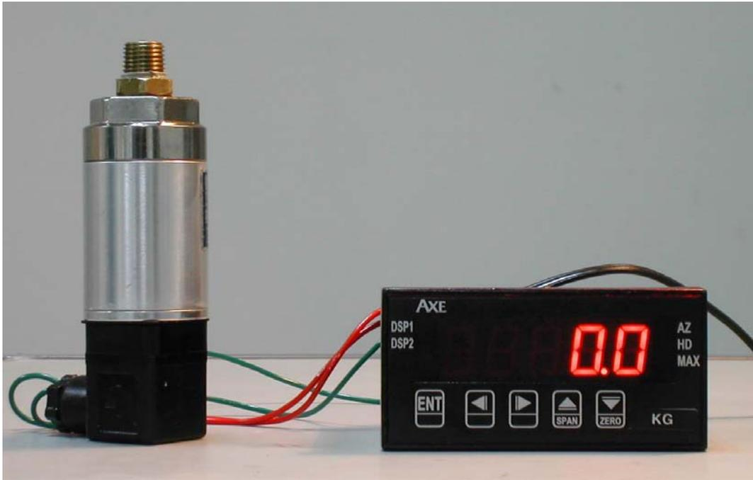
圖 4-13 壓力傳送器與數位顯示器之實體照片
