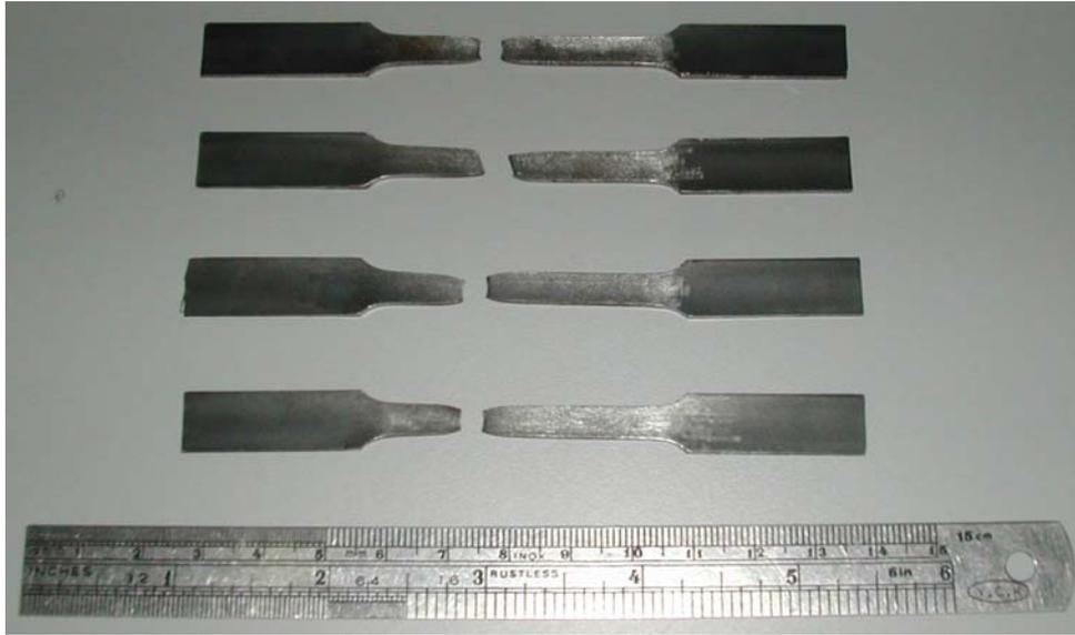
圖 5-15 拉伸試驗後之 SUS409 試片
