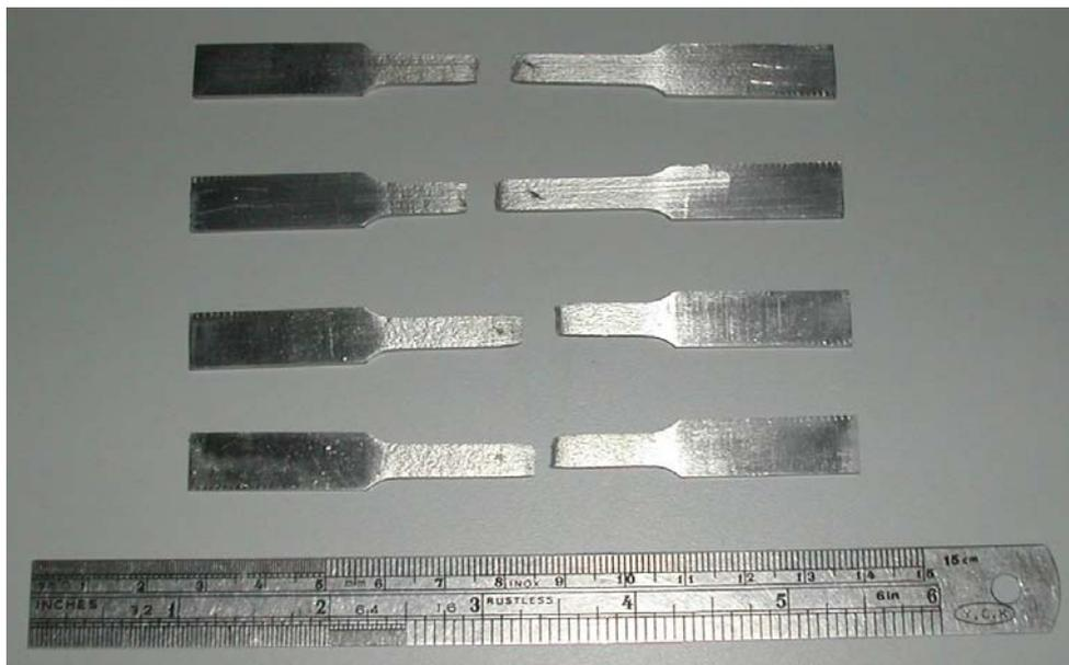
圖 5-14 拉伸試驗後之 AA6011 試片
