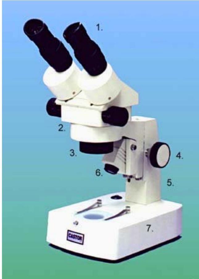
圖 2. 解剖顯微鏡
